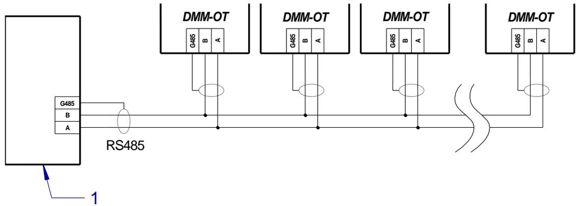
Fig. 7 - RS485 wiring example
