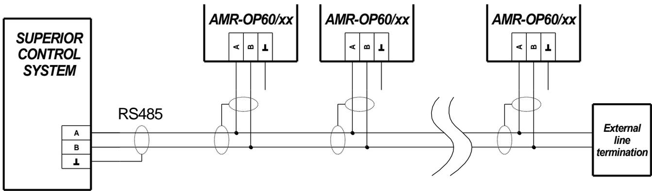
Fig. 6 - RS485 wiring
