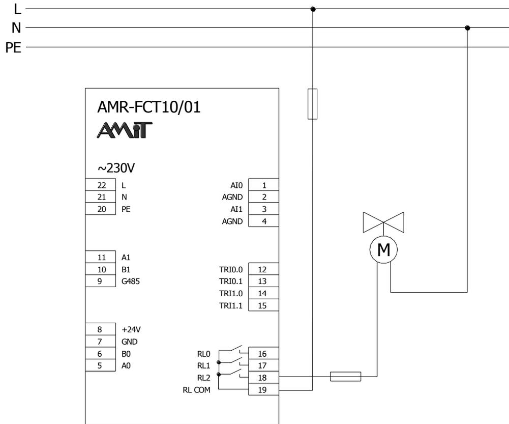
Fig. 14 – Relay output wiring example
