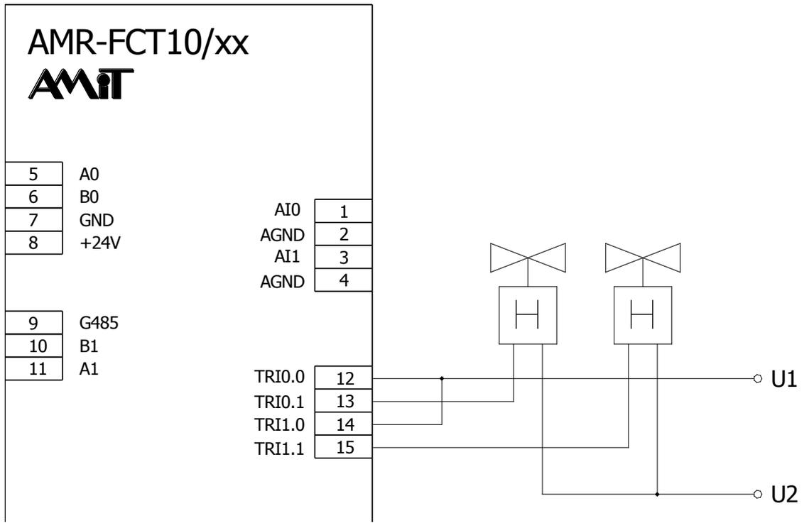
Fig. 16 – Triac output wiring example
